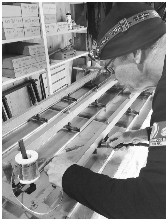
Hoogste concentratie en fijne motoriek zijn nodig bij het solderen van de absorber.
